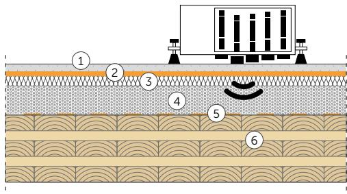
① Massetto in calcestruzzo (2000 kg/m<sup>3</sup>), (spessore: 50 mm)
