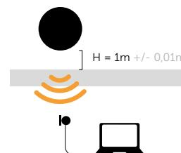
La RUBBER BALL viene utilizzata per simulare impatti "morbidi" e "pesanti", come una camminata a piedi scalzi o il salto di un bambino.
